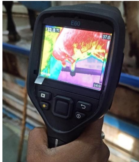
Fig. 10: Infrared thermal camera; FLIR E60
