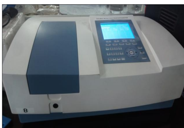
Fig. 3.20 : Double beam spectrophotometer
