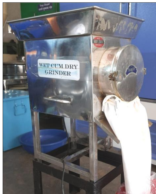
Fig. 3.4 : Pulverizer (hammer type)
