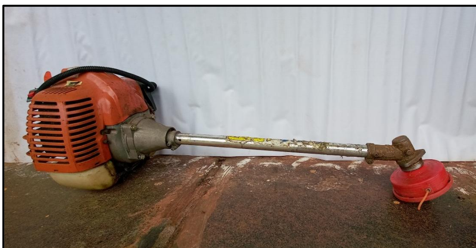
(d) Clutch housing, cutter shaft and bevel gear case
