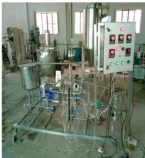
PHE module testing
