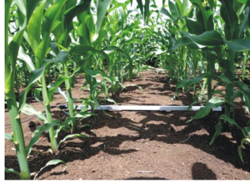
PAR observation using line quantum sensor (below canopy)
