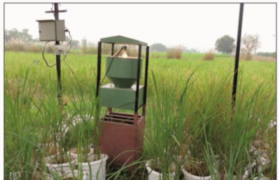
(D) Light trap installed in rice field
