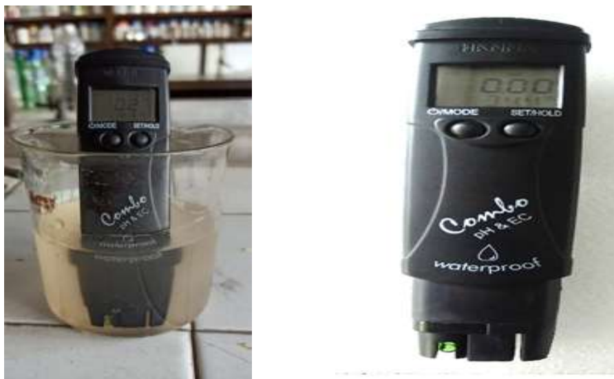
Fig. 3.4: EC- pH meter
